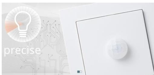
Датчик движения скрытого монтажа определяет движение людей и переключает контакт реле для управления освещением или понижения температуры в неиспользуемых помещениях. Применения датчика, доступные в различных диапазонах и цветах выключателей, - это жилые и деловые помещения, офисы и коридоры. Устройство монтируется в скрытой коробке.
