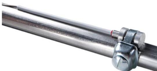
Контактный датчик с соединительным кабелем и алюминиевой призмой используется для измерения температуры поверхности труб (холодной или горячей воды) и других контактных поверхностей. В качестве аксессуаров доступны зажимной ремень / натяжной зажим и термоконтактная жидкость.
