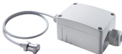
Контактный датчик с корпусом USE-S, соединительным кабелем и алюминиевой призмой используется для измерения температуры поверхности труб (холодной или горячей воды) и других контактных поверхностей. В качестве аксессуаров доступны зажимной ремень / натяжной зажим и термоконтатная жидкость.
