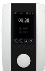
Большинство функций NOVOS Touch также доступно с NOVOS 7 - вторым флагманом. Этот мощный комнатный блок управления с высококачественным 3,5-дюймовым TFT-дисплеем и стеклянной поверхностью впечатляет своим простым вызовом и управлением меню с помощью поворотной / нажимной кнопки и имеет четыре дополнительные клавиши прямого вызова для быстрого вызова часто используемых функций или сцен.
